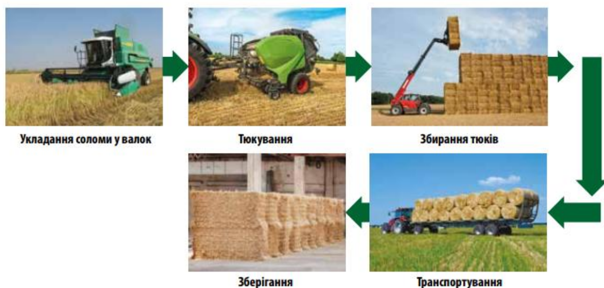
Рисунок 3.3 – Схема організації виробничого процесу по заготівлі тюкованої побічної продукції
