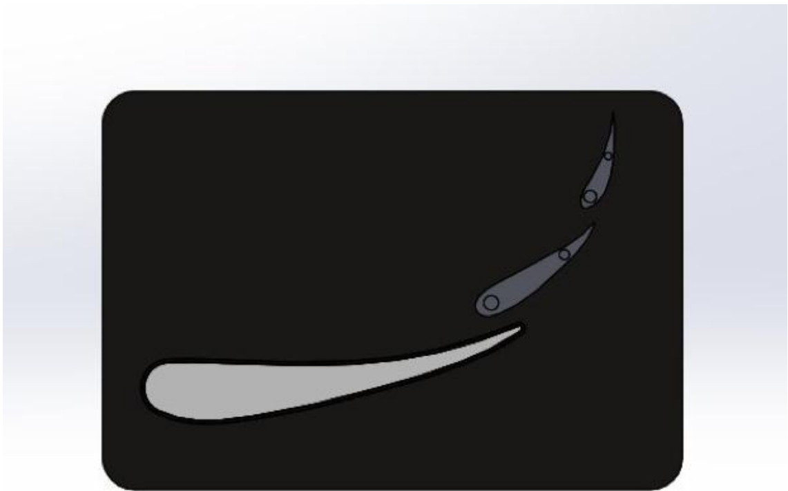
Рис. 2.15. Переріз найоптимальнішого варіанту аеродинамічного крила
