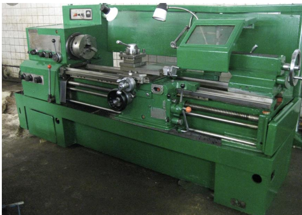
Рис. 3.5. Токарний верстат 16к20
