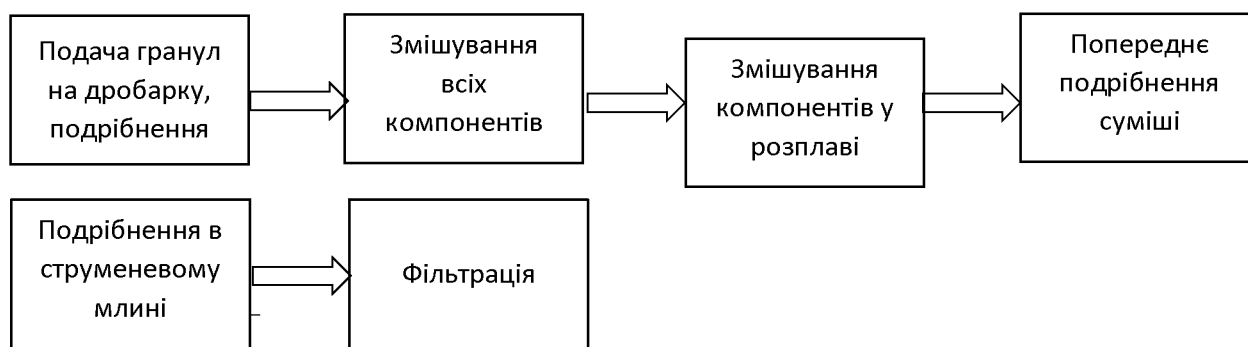
Рисунок 4.2 Принципова схема хімічного виробництва
