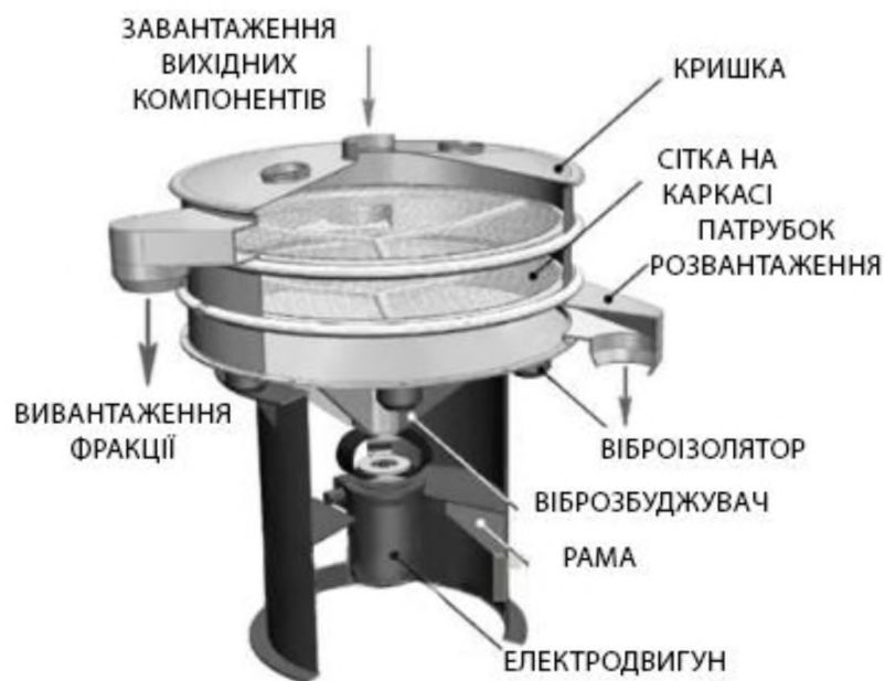
Рисунок 2.6 – ситового фільтра СВК:
