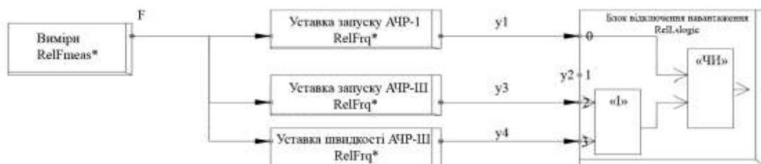
Рис. 7.11 – Структурна схема моделі АЧР1+АЧР-1Ш
