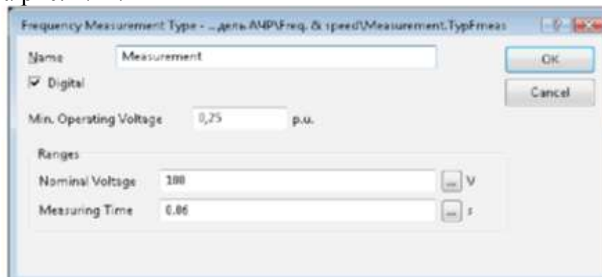
Рис. 7.12 – Діалогове вікно типу блоку «вимірювання RelFMeas»
