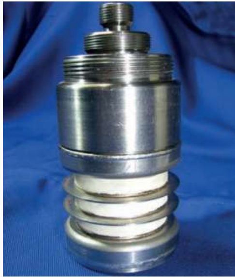
Рисунок 1.11 – Катодний вузол електронно-променевої гармати [8, с.35]
