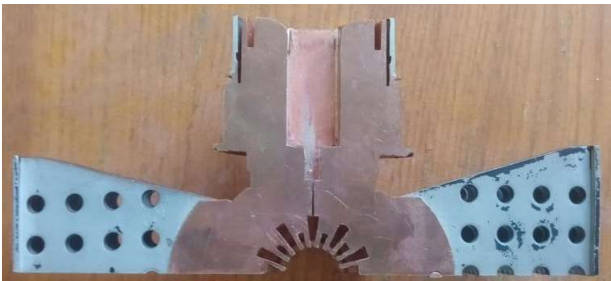
Рисунок 2.12 – Поперечний розріз анодного блоку магнетрона МІ-241
