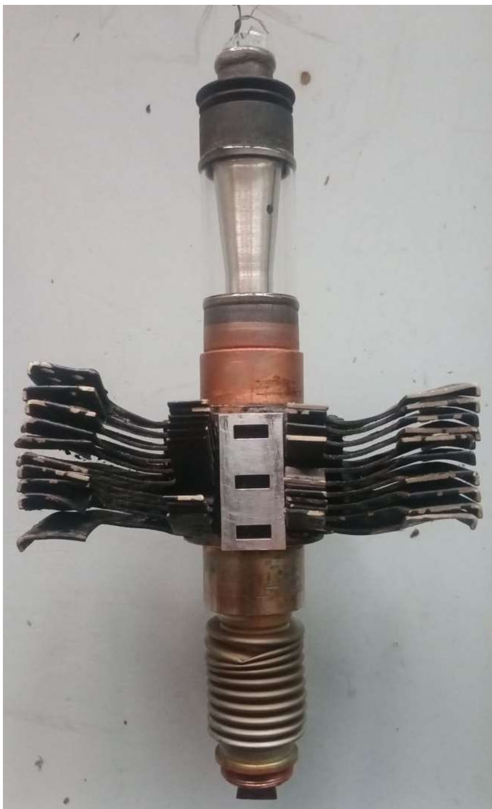
Рисунок 2.4 – Розташування оправки для заміру магнітного поля на анодному блоці магнетрона
