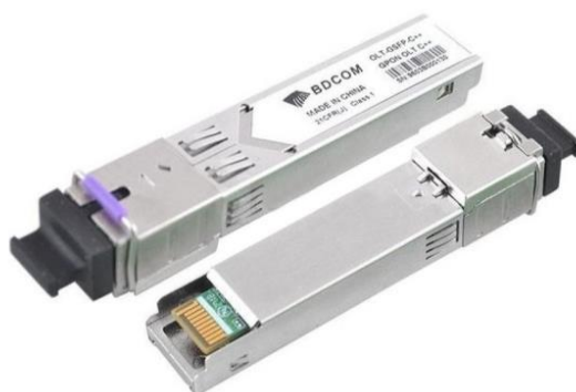
Рисунок 3.4 - Модуль оптичний BDCOM GPON OLT-GSFP-C++
