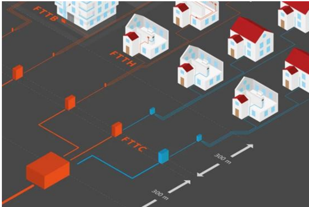
Рисунок 1.15 - Загальний принцип реалізації FTTC [10]
