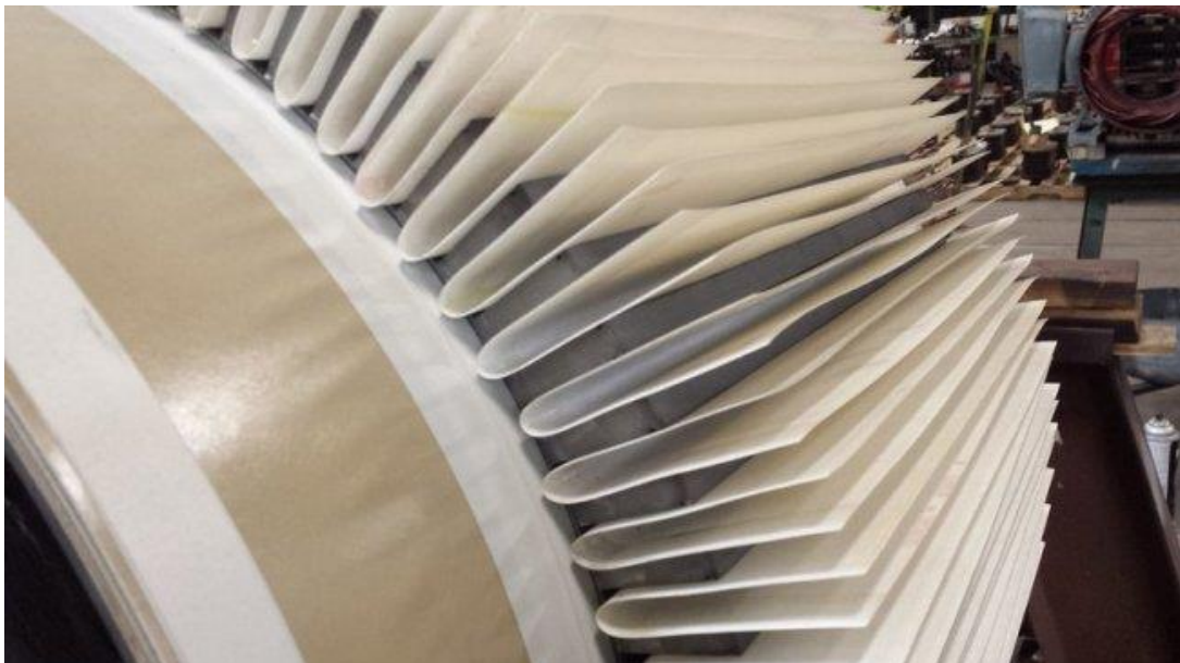
Рис. 2.7 - Паперова ізоляція при перемотуванні електродвигуна
