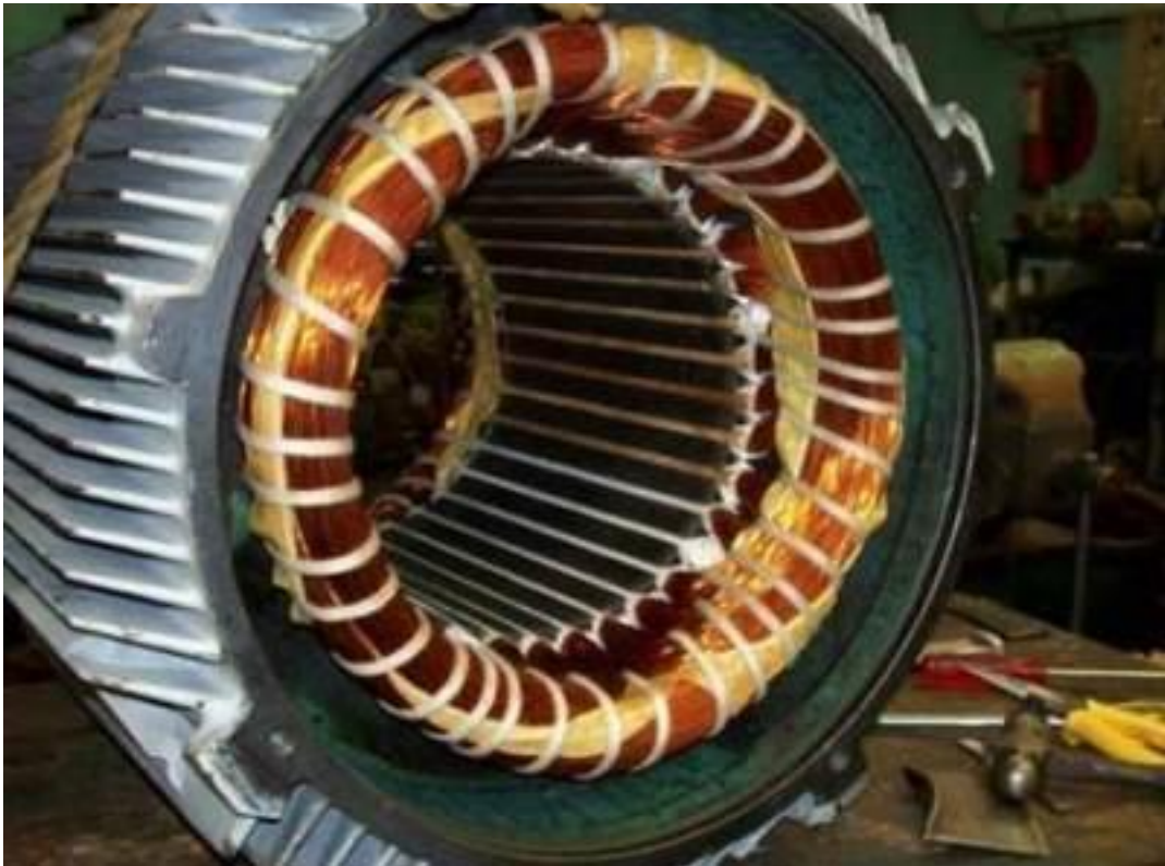
Рис. 2.2 - Статор із обмотками трифазного асинхронного двигуна
