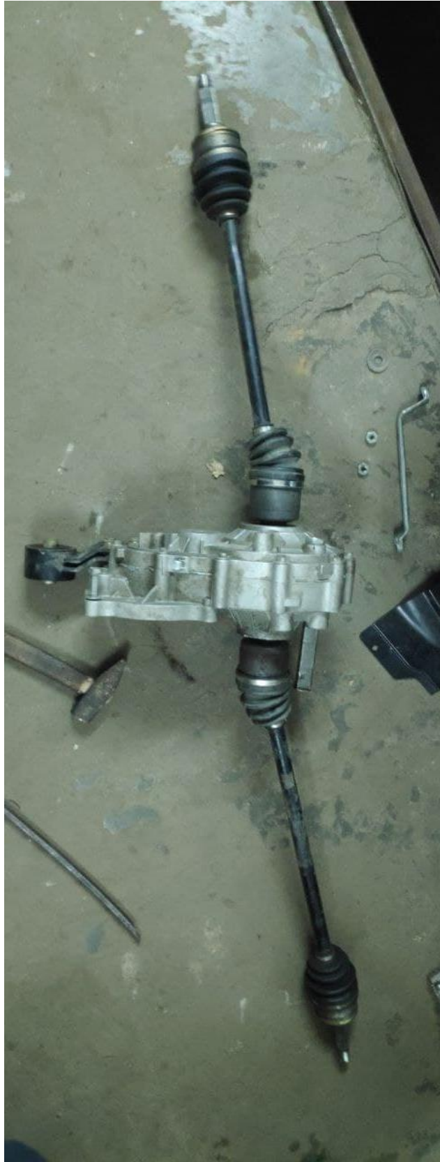
Рисунок 4.8 – Штатний редуктор з диференціалом та полуосями кузова LSEV.
