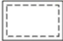
Рисунок 4.4 – Закріплення плати, спирання на 4 сторони
