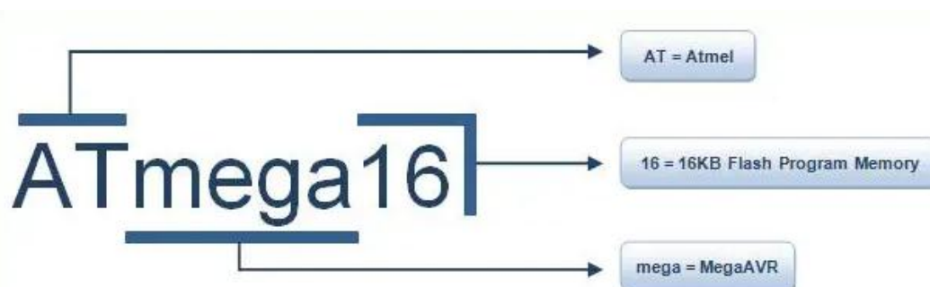
Рисунок 2.3 – Принцип іменування мікроконтролерів AVR [8]
