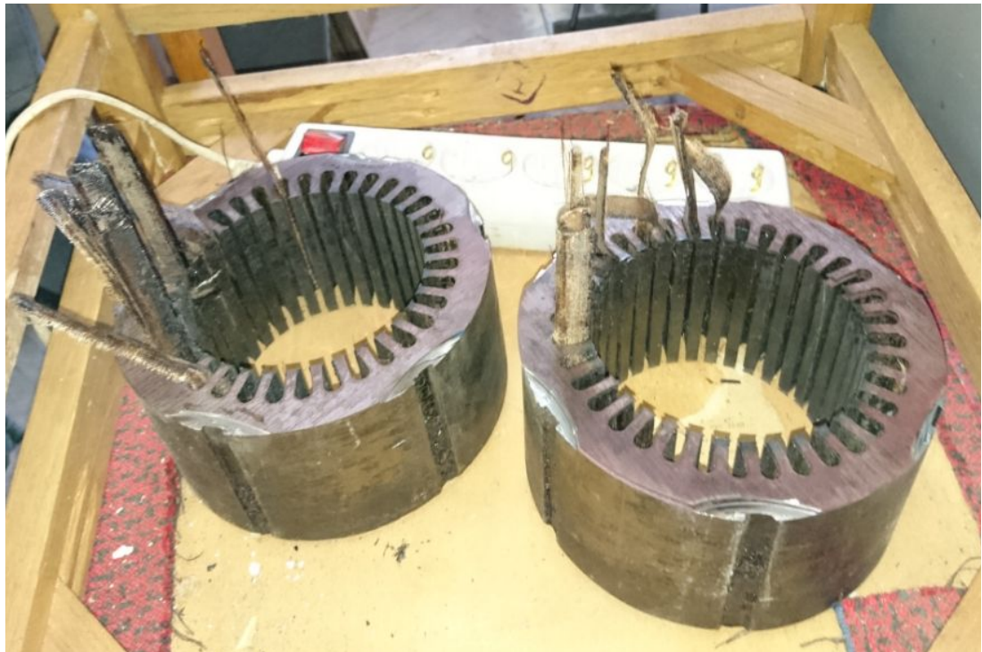
Рисунок 2.6 – Розпиляний магнітопровід АД серії 4А90L2У3
