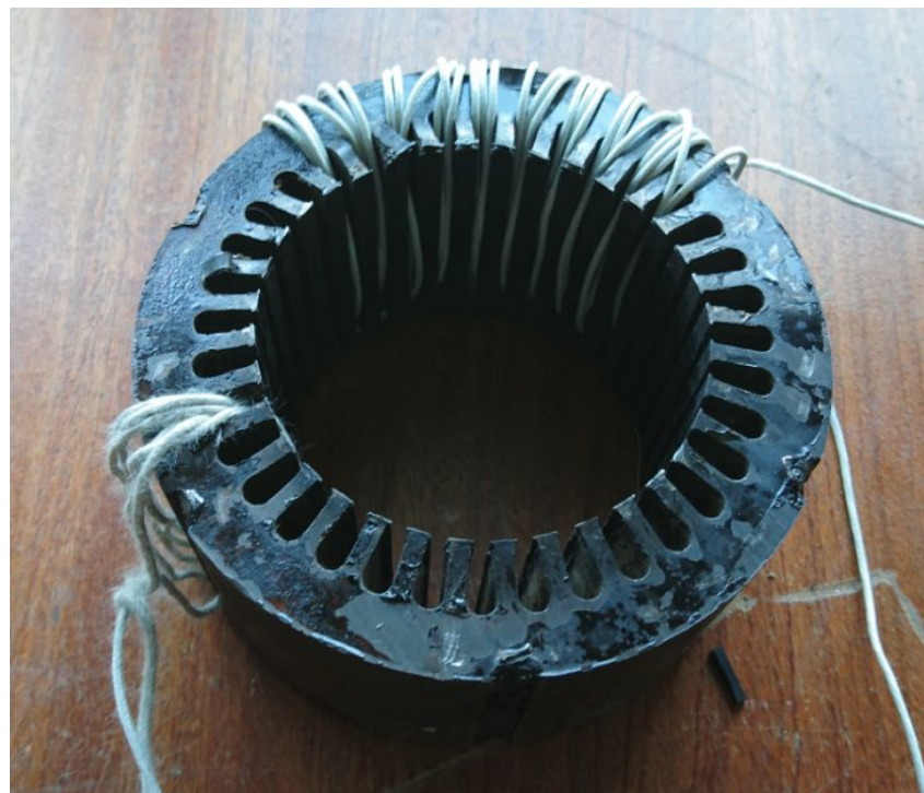
Рисунок 2.5 – Частина магнітопроводу АД серії 4А90Л2У3 3 кВт
