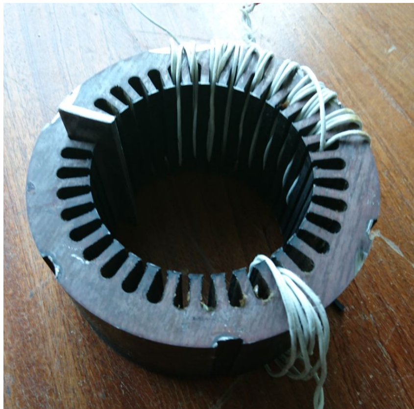
Рисунок 2.7 – Навмисно пошкоджена частина магнітопроводу АД серії 4А90L2У3 3 кВт
