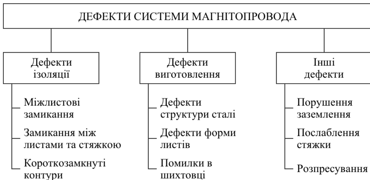
Рисунок 1.1 – Класифікація дефектів магнітопроводу
