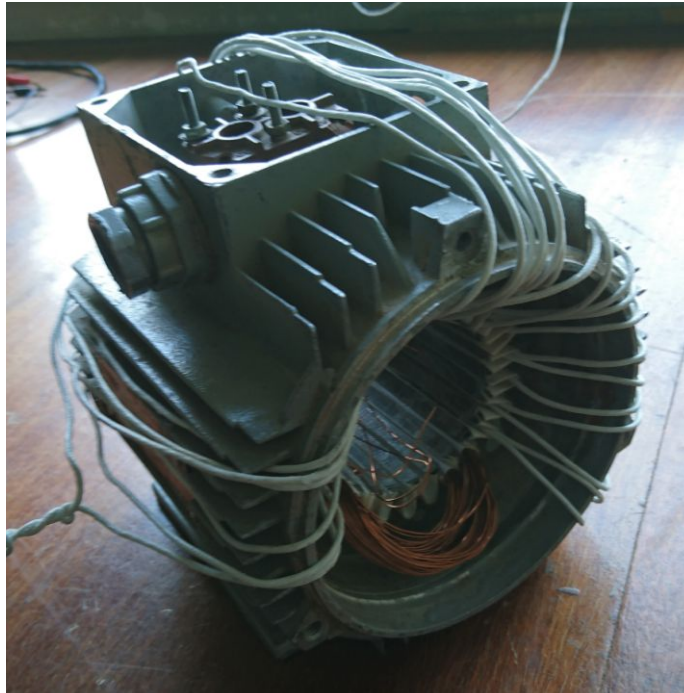
Рисунок 2.2 – Магнітопровід АД серії 4AA63B4Y3 0,37 кВт в корпусі З рівняння (2.1) напруга буде дорівнювати:
