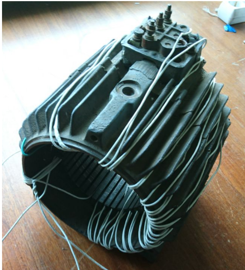
Рисунок 2.8 – Магнітопровід АД серії 4A100L6Y3 2.2 кВт в корпусі
