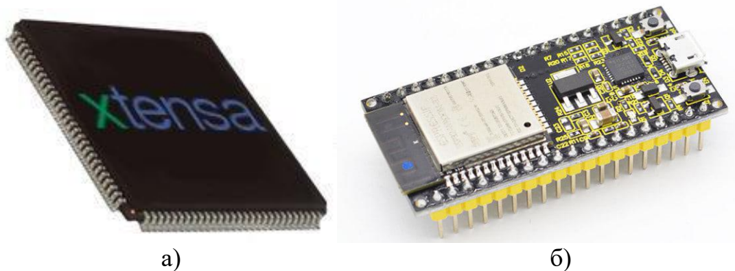
Рисунок 1.8 – Мікропроцесорна та мікроконтролерна техніка: а) мікропроцесор Tensilica Xtensa LX106 [23]; б) мікроконтролер ESP32 [25]
