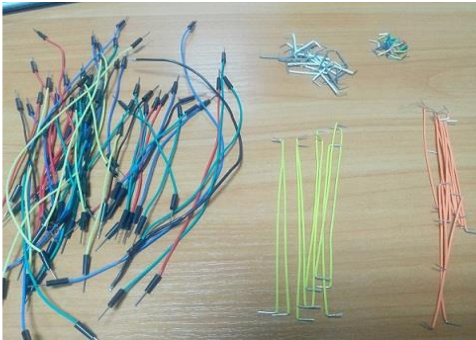
Рис. 2.3. Дроти-перемички, що використовуються для безпачних макетних плат
