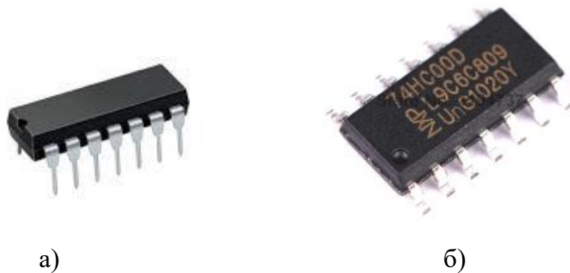
Рис. 1.5. Загальний вигляд мікросхем логічного елемента І-НІ 74HC00: а) у корпусі DIP-14; б) у корпусі SOIC-14
