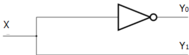
Рис. 3.5. Приклад реалізації найпростішого дешифратора 1 в 2
