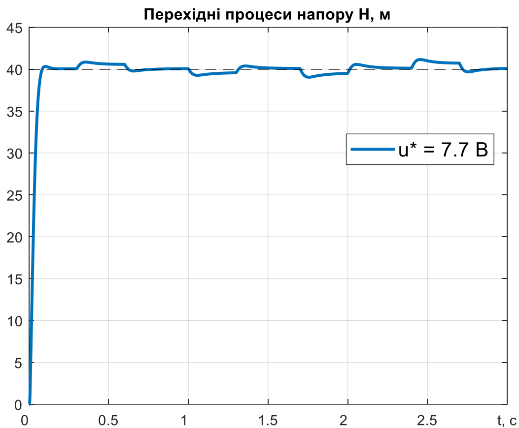
Рисунок 5.15 – Реакція системи на «стрибок» 7.7 В
