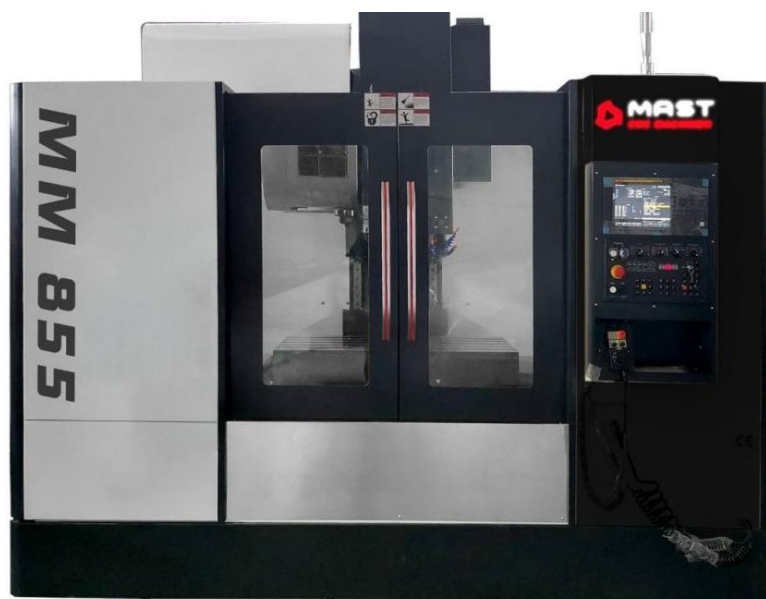
Рисунок 2.15 – Обробляючий центр MAST MM855 S24 [9]
