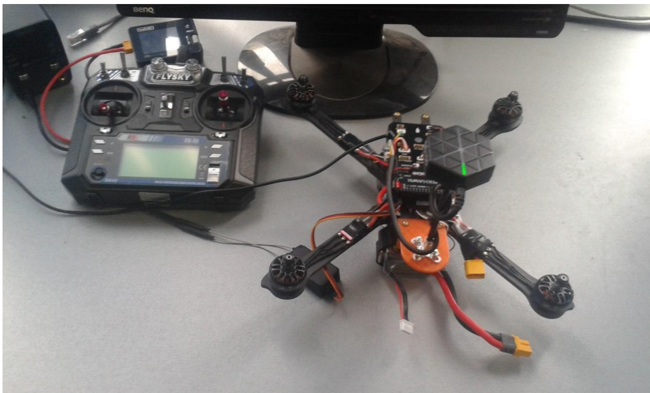
Рисунок 4.1 Дрон з технологією Follow Me на основі даних GPS та BT
