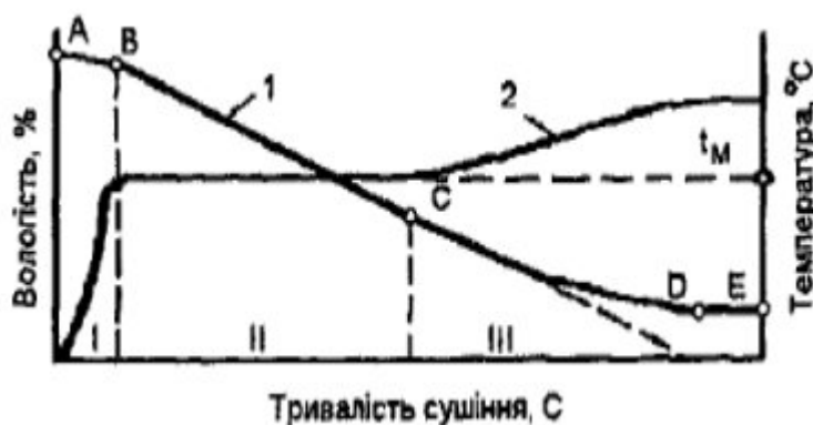
Рисунок 5 – Криві зміни вологості полотна і його температури по стадіях сушіння: 1 – вологість полотна; 2 – температура полотна; I – період нагрівання; II – сушіння з постійною швидкістю; III – сушіння зі зменшуваною швидкістю
