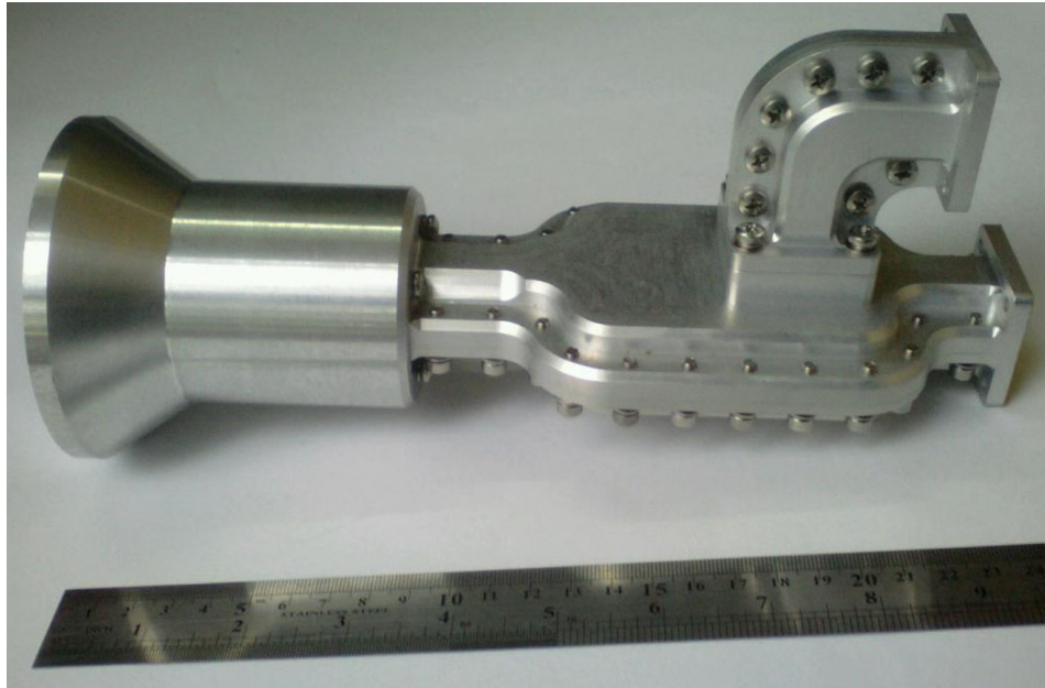
Опромінювально-перетворювальний модуль Ku-діапазону частот для прийому сигналів із ортогональними лінійними поляризаціями.
