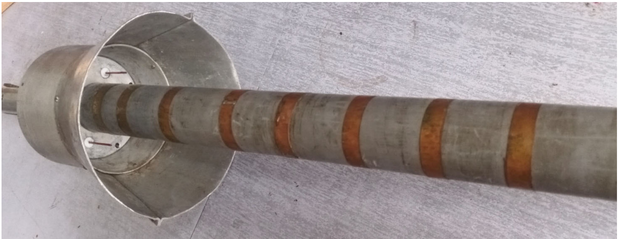
Рисунок 2.11. Діелектрична труба навантажена металевими кільцями.
