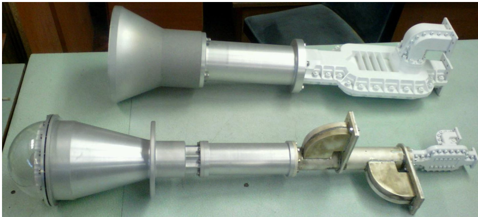
Опромінювально-перетворювальний модуль С-діапазону частот для прийому сигналів із ортогональними коловими поляризаціями (зверху) і дводіапазонний опромінювально-перетворювальний модуль С/Ku діапазонів частот (знизу).
