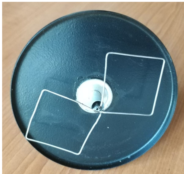
Рисунок 21.10. Конструкція зигзагоподібної антени без захисної кришки.
