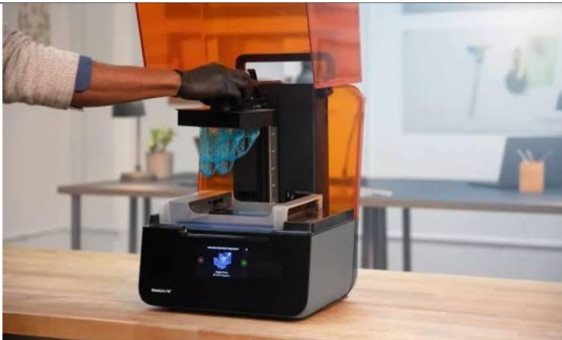
Рис. 1.12 . Друк медом пошарового сплавлення рідкої смоли
