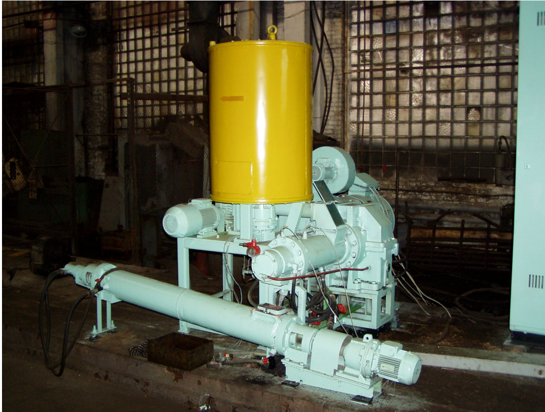
Рис. 3.3. Фотознімок черв'ячно-роторного диспергатор-екструдера ДЕКЧЕР-150 (індекс 514112) виробництва АТ «Перший київський машинобудівний завод» (колишнє ВАТ «НВП „Більшовик”», м. Київ) (фото автора, 31.05.2007)
