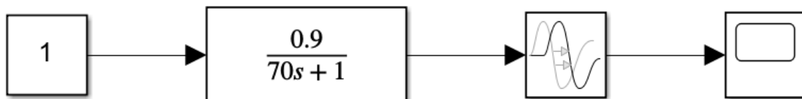
Рисунок 2.8 — Схема побудови перехідного процесу об'єкту управління
