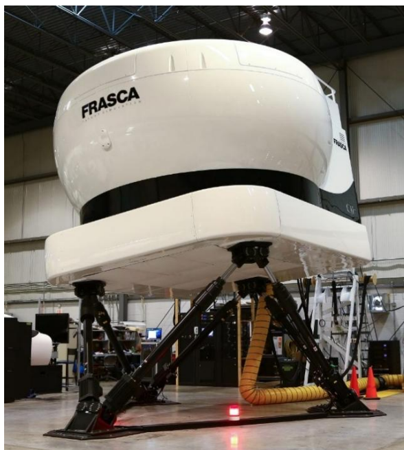
Рисунок 1.1 – Авіаційний тренажер на базі паралельної кінематики (гексапода)
