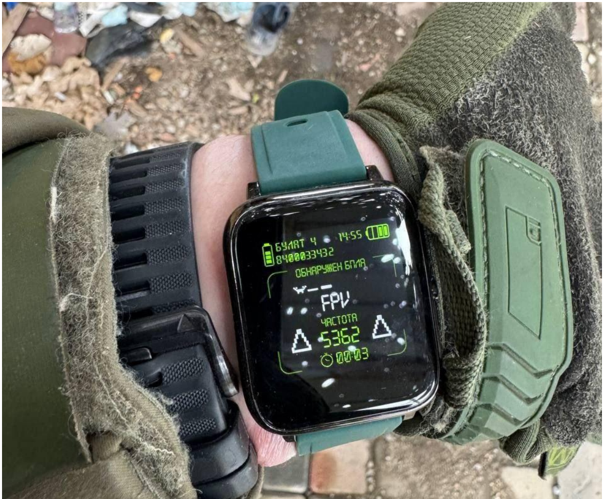
Рисунок 1.4 — Приклад використання смарт-годинника для передачі інформації від детектора дронів [4].
