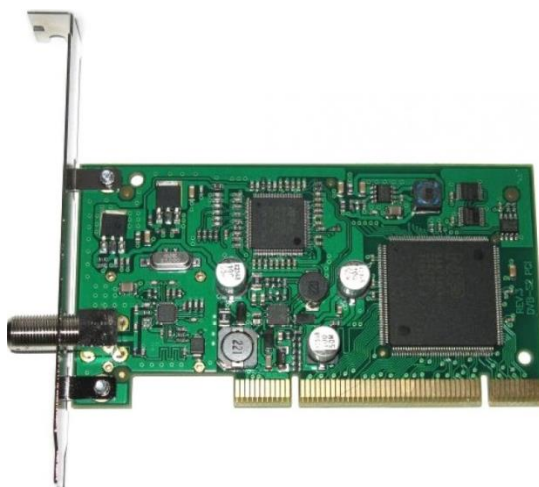
Рис. 2.21. Зовнішній вигляд печатної плати ресивера Omicom S2
