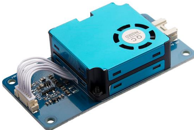
Рис.2.13. HM3301 - Оптоелектронний (лазерний) датчик концентрації пилу (PM2.5)
