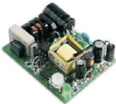
Рисунок 3.16 — Блок живлення контролера [19]
