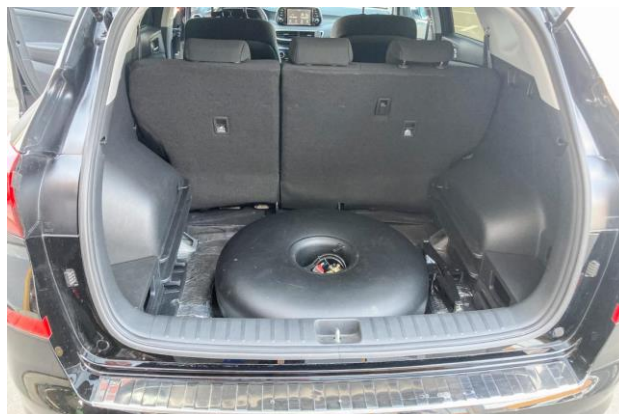
Рисунок 4.5 — Встановлення резервуару до автомобілю
