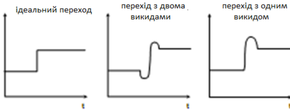
Рисунок 15 – Перехідна характеристика ЦАП (з паразитними викидами)
