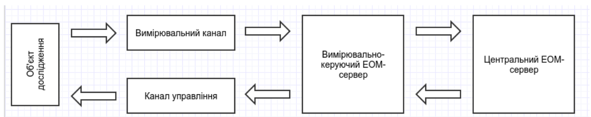
Рисунок 1 - Схема розподіленої вимірювально-керуючої системи
