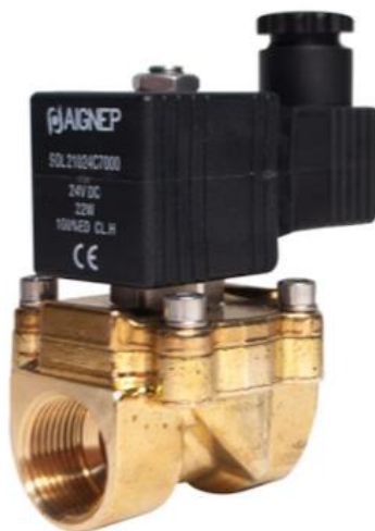
Рис. 2.8. Електроклапан 2/2 NC EPDM 03F 0-16 BAR DN25 KV6,63[10]
