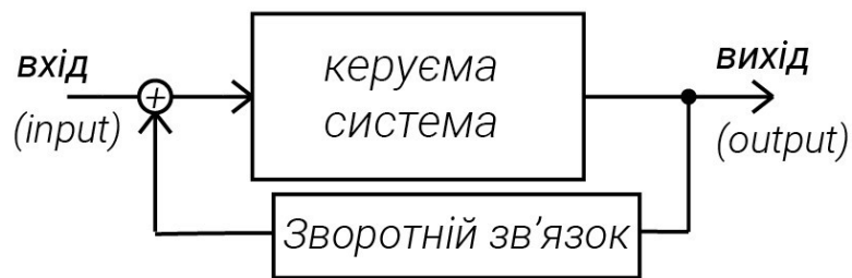
Рисунок 1.2 – Активне керування замкнутого циклу зі зворотнім зв'язком
