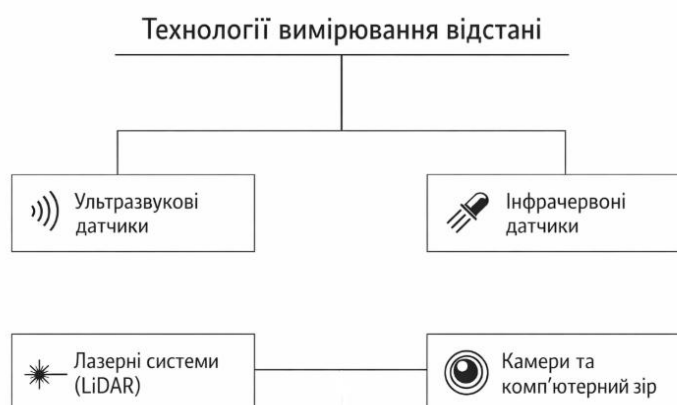
Рисунок 1.4 — Основні технології вимірювання відстані в мобільних робототехнічних системах.
