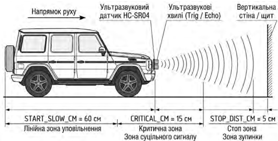
Рисунок 5.1 — Схема експериментального стенда для дослідження алгоритму автопаркування
