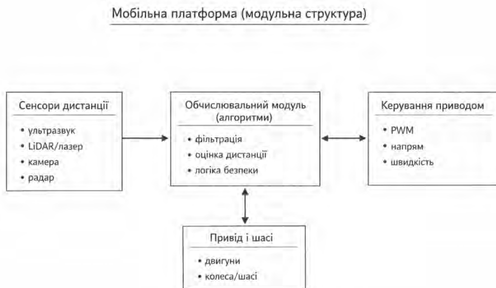
Рисунок 1.1 — Узагальнена структура мобільної платформи з системою автоматичного моніторингу дистанції.
