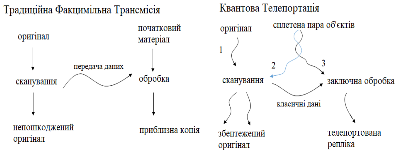
Рисунок № 2.2 – Порівняння квантової телепортації з традиційною факсимільною передачею даних
