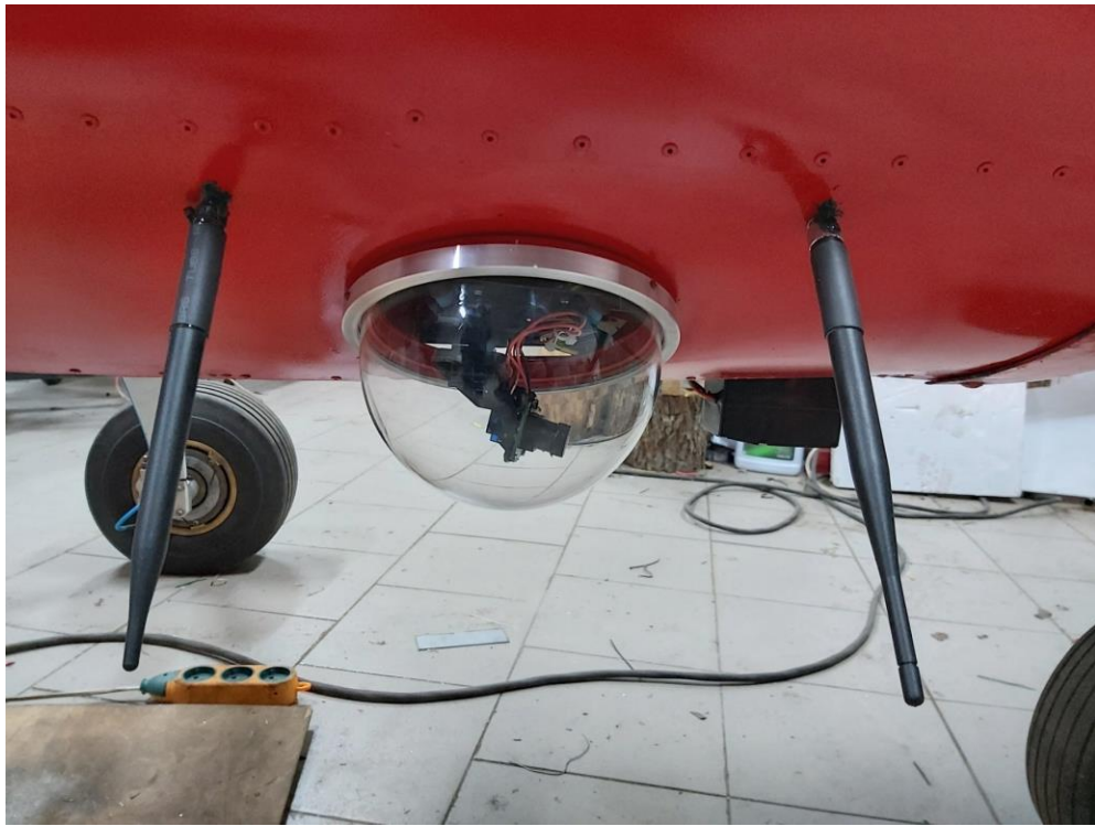
Рисунок 3.3 - Вбудована камера в безпілотний літальний апарат для відеоспостереження
