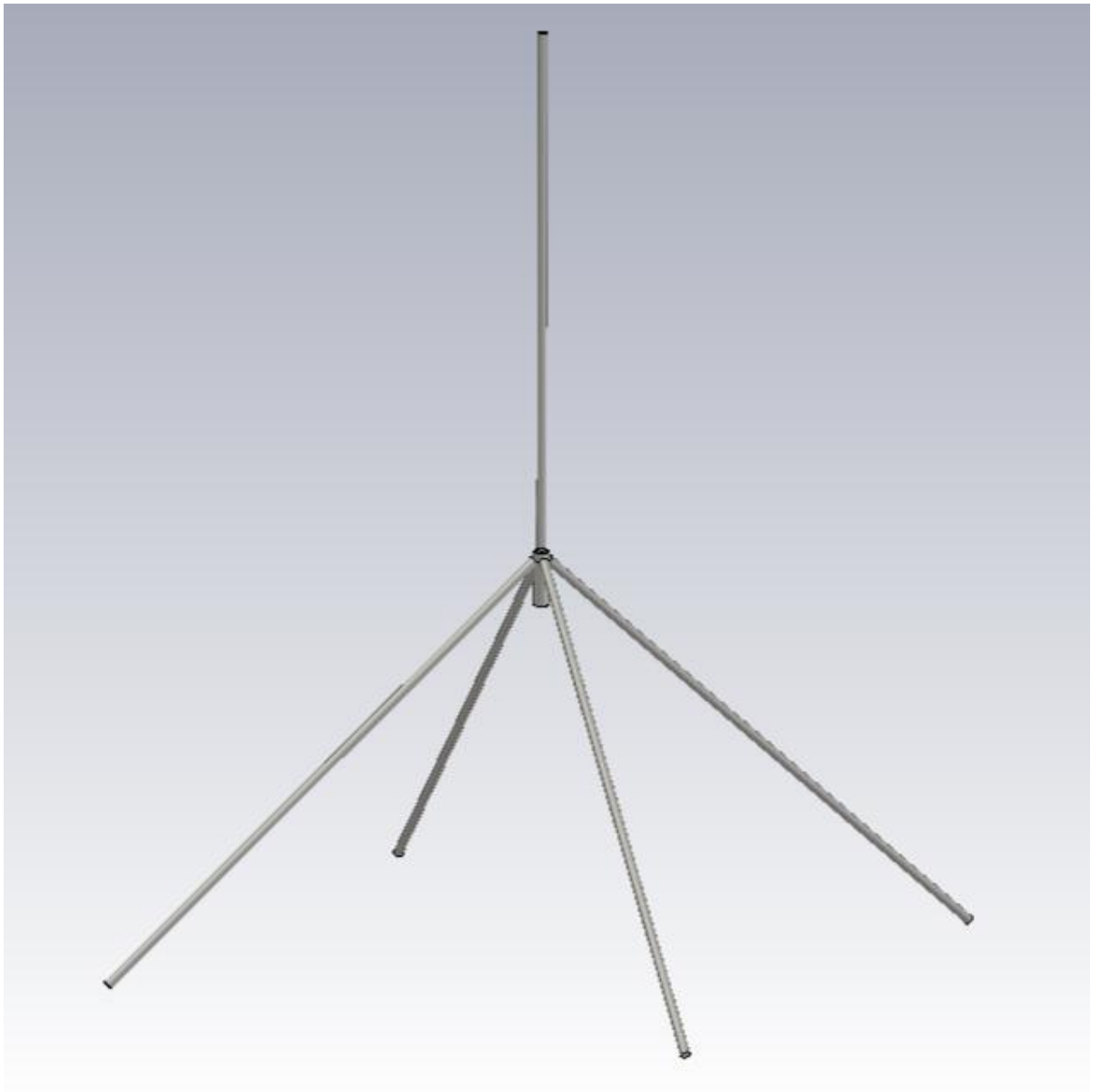
Рисунок 2.2 — 3D-модель Ground Plane антени на 433 МГц
