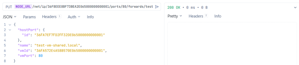
Рисунок 4.24 – Створення правила пресилки
