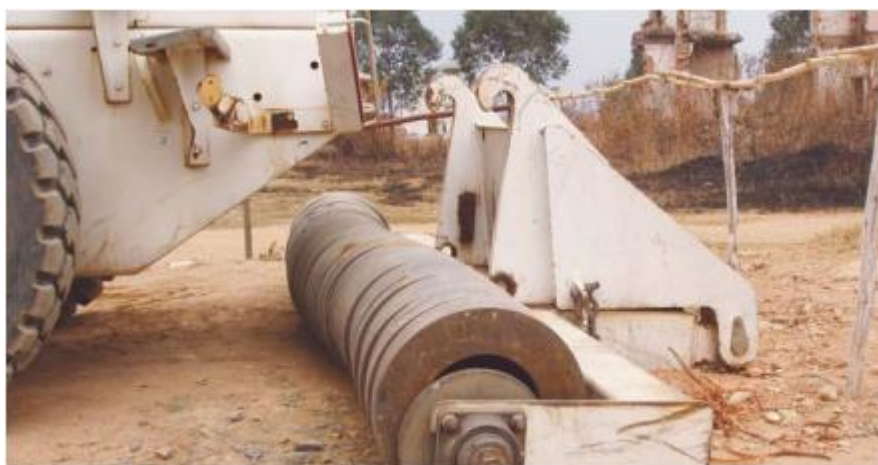
Рис. 1.5 Роздільний катковий трал з можливістю огинання рельєфу [7]
