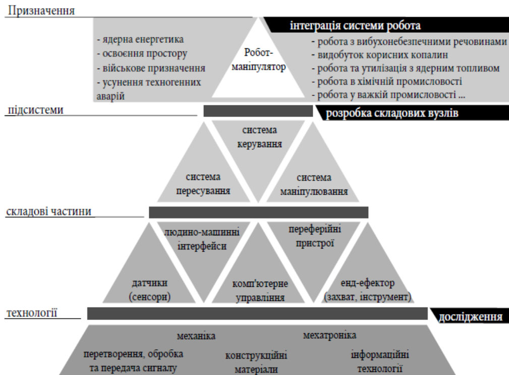
Рис.5. Модульний підхід проектування робота-маніпулятора
