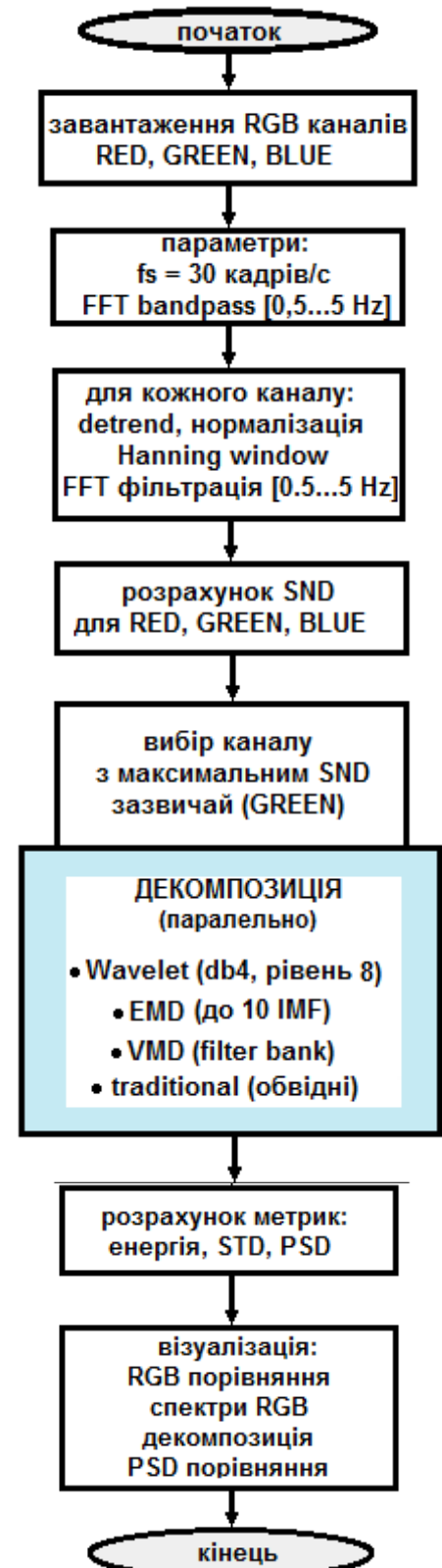
Рисунок 3.16 – Блок-схема обробки відеосигналів (ДФПГ)
