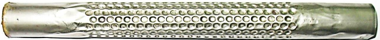
Рис. 12 Загальний вигляд (фото) дослідженої труби із заглибленнями.
