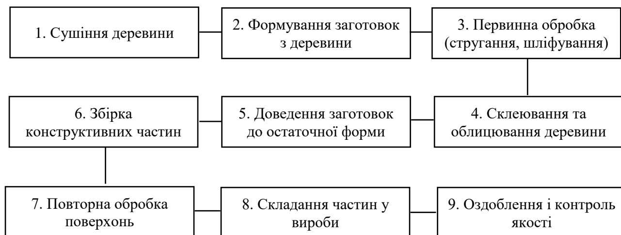
Рисунок 2.2 – Етапи технологічного процесу меблевого виробництва на ТОВ «К'Лен»
