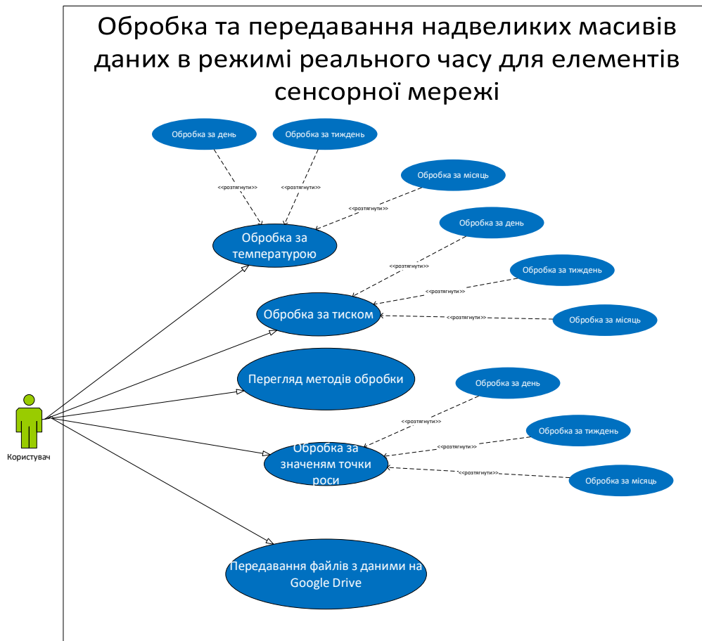
Рисунок 4.15 — Use-case діаграма для користувача системи
