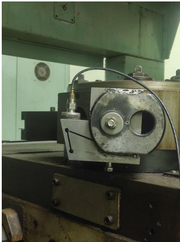
Рисунок 5.21 Дослідний різцетримач встановлено в інструментальне кріплення револьверної головки
