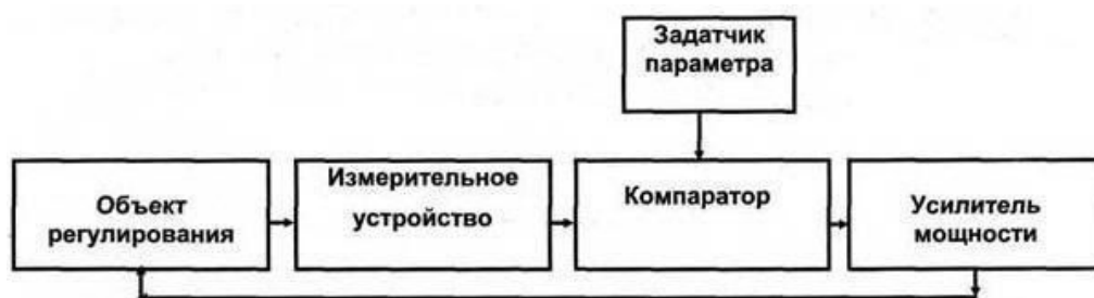
Рис. 4.1. Функціональна схема регулювання керування
