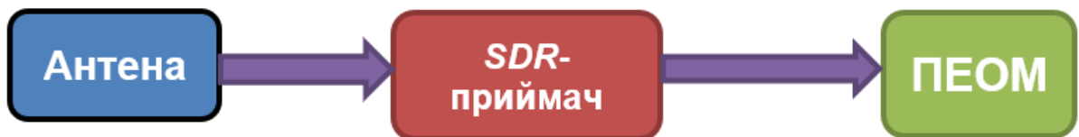
Рисунок 3.8 – Схема підключення устаткування
