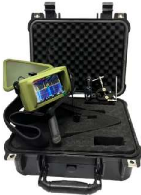
Рисунок 3.31 – Варіант компоновки портативного пристрою радіотехнічної розвідки на базі аналізатора спектру TINY SA ULTRA
