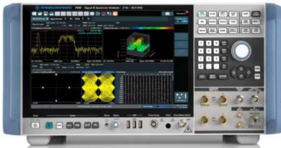
Рисунок 3.12 – Аналізатор сигналів R&S FSW з відображенням векторної діаграми сузір'їв багатопозиційних сигналів
