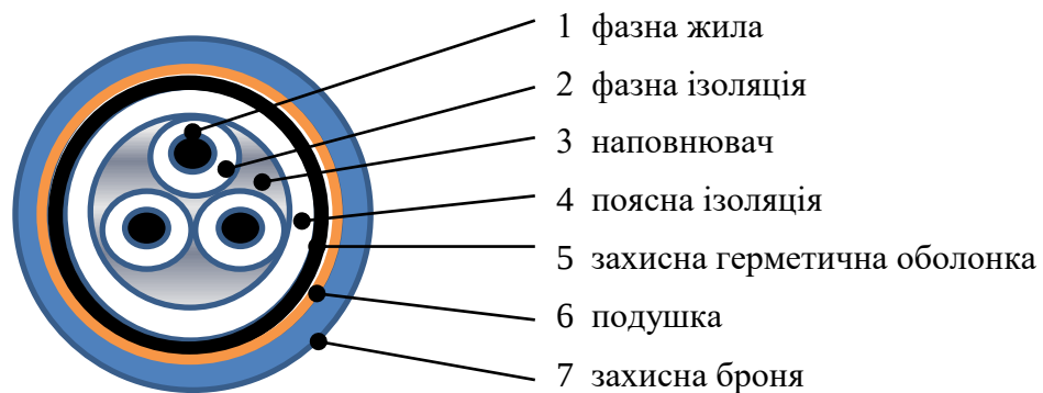
Рис. 7.4 Конструкція броньованого кабелю
