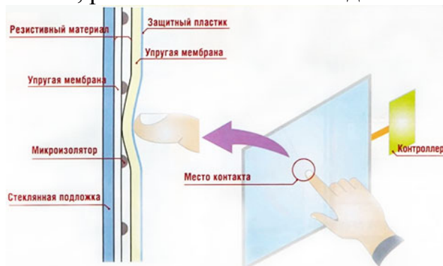
Рис. 1. Конструкція резистивного екрану
