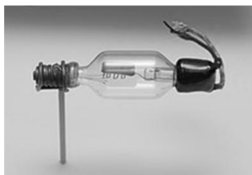
Рис. 1.1. Фотографія першої тріодної електронної лампи Лі де Фореста [110]
