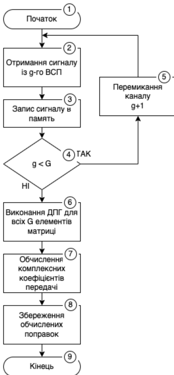
Рис. 4.1. Графічне представлення алгоритму нормалізації каналів ВСМ
