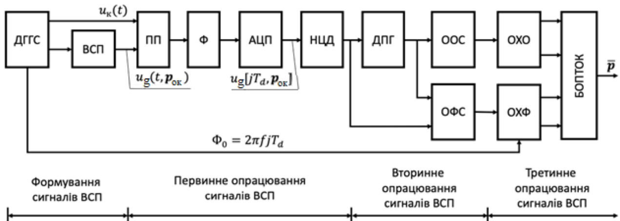
Рис. 2.4. Структурно-логічна схема формування та опрацювання сигналів ВСК з використанням ДПГ, що реалізується в чотири етапи
