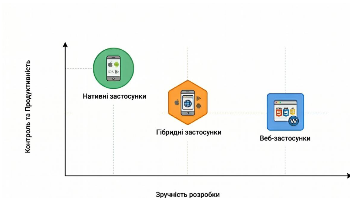
Рис. 7. Відмінності типів програмного забезпечення в залежності від цільової платформи
