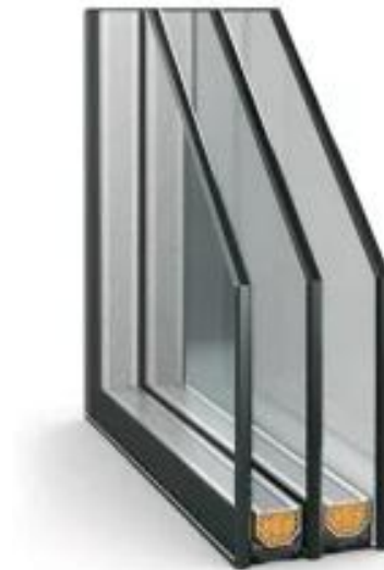
Рисунок 3.2 – Двокамерний склопакет (32 мм 4-10-4-10-4)
