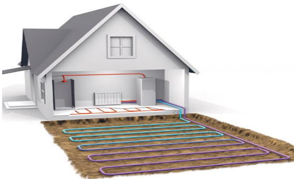
Рисунок 2.5 - Схема теплообміну закритого способу
