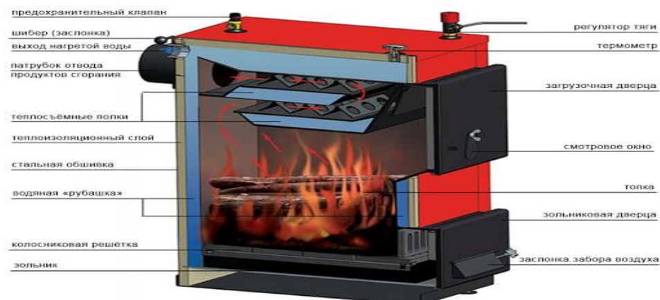
Рисунок 1.3 – Конструктивна схема твердопаливного піролізного котла
