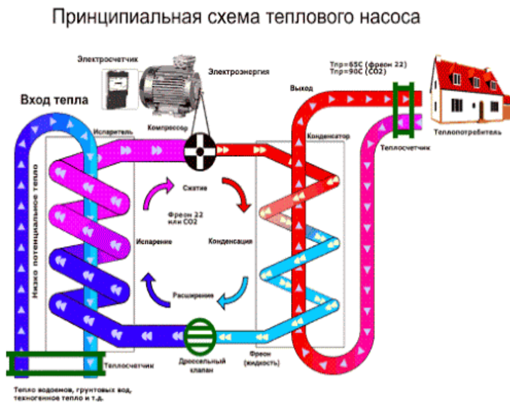
Рисунок 1.4 – Конструктивна схема теплового насосу
