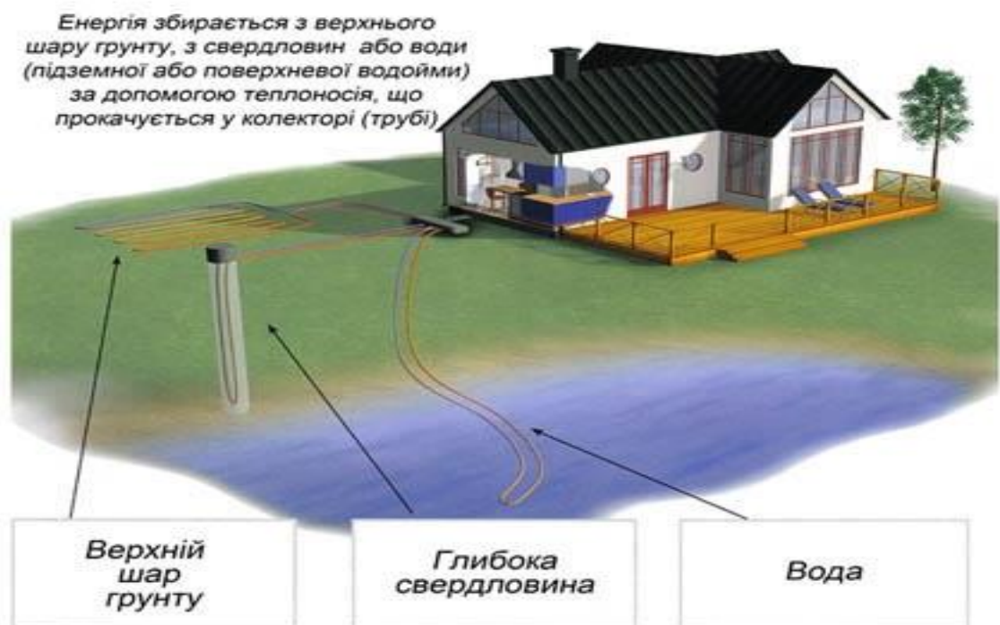
Рисунок 2.2 - Принцип відбору геотермального тепла
