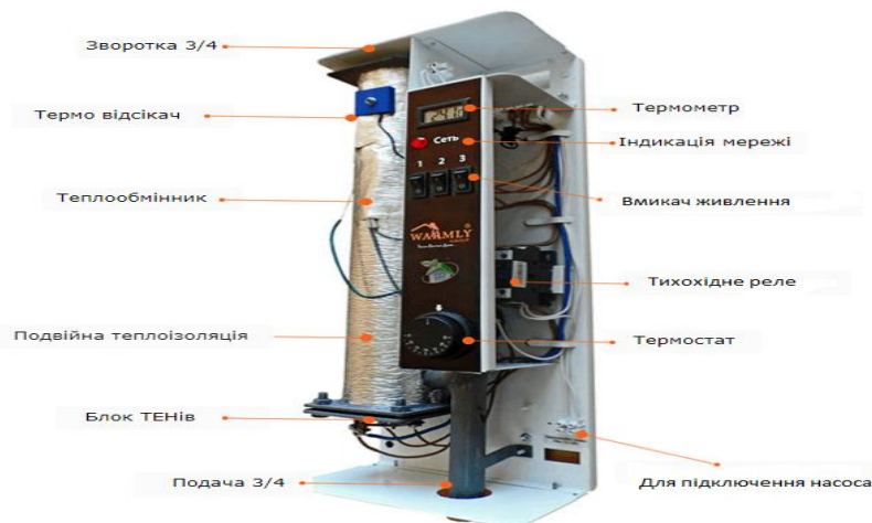
Рисунок 1.2 – Конструктивна схема електричного котла
