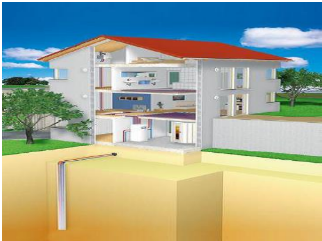
Рисунок 2.6 - Схема теплообміну закритого способу і вертикальним теплообмінником
